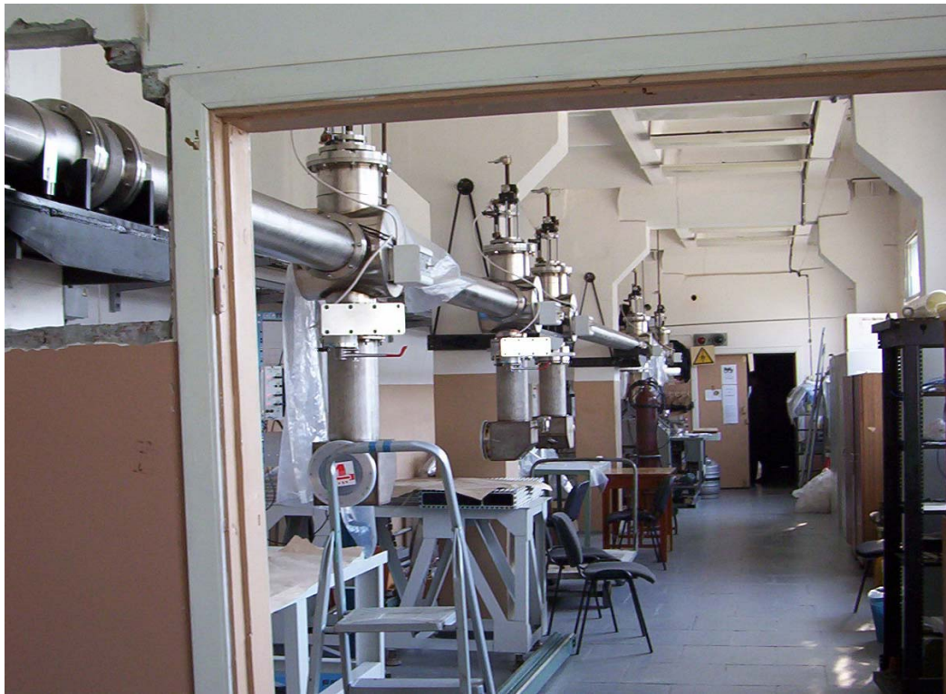
Рис. 3. Канал в зале для пользователей. Видны спуски к экспериментальным станциям.
