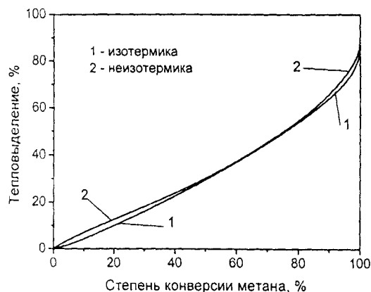
Рис. 3. Зависимость тепловыделения от степени превращения метана в изотермических (1) и неизомермических (2) условиях. Смесь 1.5% CH 4 +воздух, 1 - P_0=0.1 МПа, T_0=300 K, \varphi=100 K/с, v=10 см/с, 2 - T=1000 K.
