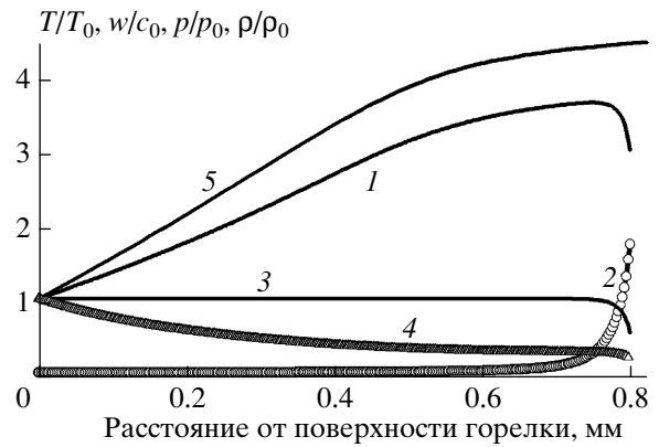
Рис. 10. Осевое распределение параметров потока для z_0 = 0.8 мм (1 – T/T_0 , 2 – w/c_0 , 3 – p/p_0 , 4 – \rho/\rho_0 , 5 – T/T_0 без зонда).
