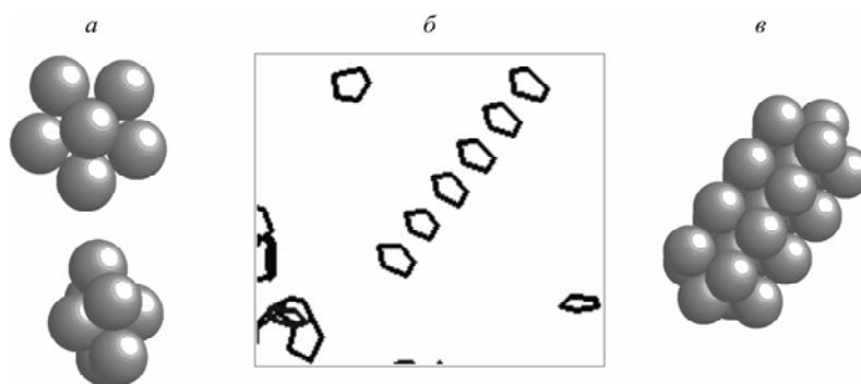
Рис. 5. Конфигурация атомов, соответствующая стопке пятичленных колец из хороших тетраэдров. Конфигурация, соответствующая одному пятичленному кольцу (декаэдр), в разных проекциях (а). Фрагмент рис. 4, а со стопкой таких колец (б). Соответствующая конфигурация атомов, полидекаэдр (в)
