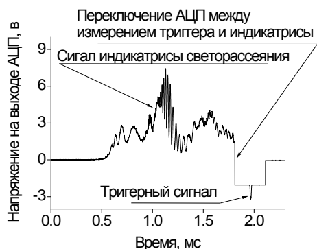
Рис. 3. Регистрируемый на СПЦ сигнал светорассеяния от одиночной клетки: большему времени соответствует меньший угол светорассеяния
