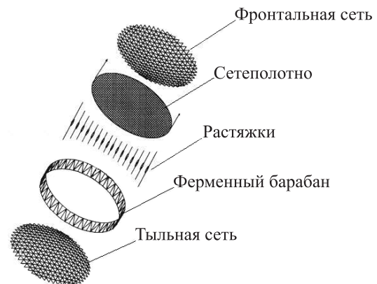
Рис. 2. Основные компоненты конструкции рефлектора
