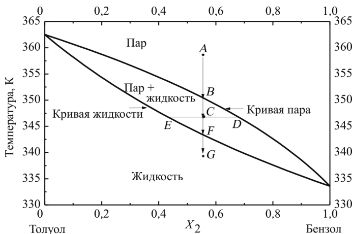
Рис. 14.2. Диаграмма состояния «температура – состав» для системы «толуол–бензол» при общем давлении 0,53 бар (диаграмма кипения при указанном давлении)
