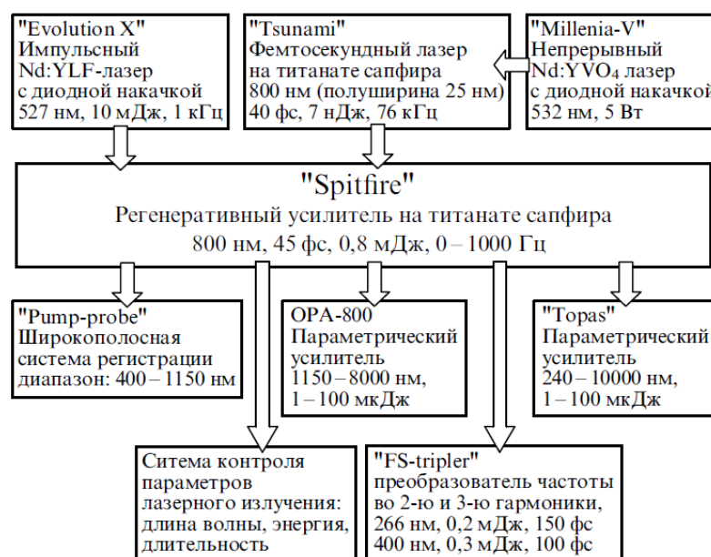
Рисунок 3.3. Блок-схема основных лазерных компонентов комплекса ЦКП «оптико-спектральные исследования» Института спектроскопии РАН.
