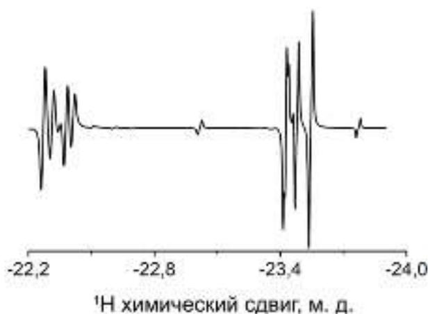
**Рисунок 38.** Усиленный гидридный  $^1\text{H}$  ЯМР спектр образца №2, зарегистрированный  $45^\circ$  импульсом сразу после барботирования параводородом в течение 10 минут.
