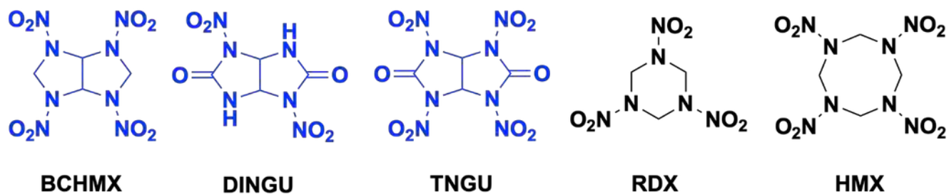
Рисунок 1 — Структурные формулы бициклических нитраминов BCHMX, DINGU, TNGU и родственных моноциклических нитраминов RDX (гексоген) и HMX (октоген)
