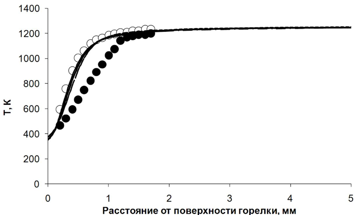
Рисунок 45. Профиль температуры в пламени смеси  $\text{H}_2/\text{O}_2/\text{N}_2$ , D=7.7%,  $\phi = 2$ . Линии – моделирование свободно распространяющегося пламени с помощью механизмов Куррана [244] (сплошная линия), Коннова [245] (пунктирно-пунктирная линия) и GRI 3.0 [228] (пунктирная линия); темные символы – измерения в невозмущенном пламени в отсутствие пробоотборника; светлые символы – измерения в присутствии пробоотборника (расстояние между термопарой и пробоотборником - 0.2 мм).
