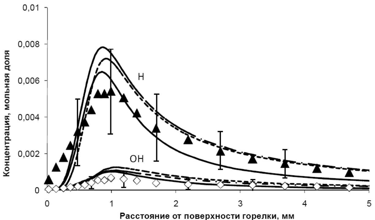
Рисунок 44. Профили концентраций Н и OH в пламени смеси  $\text{H}_2/\text{O}_2/\text{N}_2$  D=9%  $\phi=1.1$ . Линии – моделирование по измеренному под кончиком пробоотборника профилю температуры с использованием механизмов Куррана [244] (сплошная линия), Коннова [245] (птихпунктирная линия) и GRI 3.0 [228] (пунктирная линия); символы – результаты измерения методом МИМС, с учетом сдвига по формуле (2.29).
