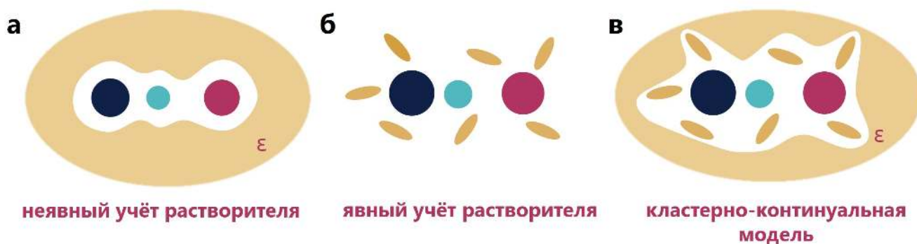
Рис. 2.8. Схематическое представление трёх подходов к учёту растворителя при стационарном квантово-химическом моделировании прочных водородных связей: а — континуальная модель IEFPCM с диэлектрической проницаемостью \varepsilon(N, T) , б — явный учёт нескольких молекул растворителя в первой сольватационной сфере, в — кластерно-континуальная модель, сочетающая явное описание ближайших молекул растворителя с континуальным представлением остального окружения.
