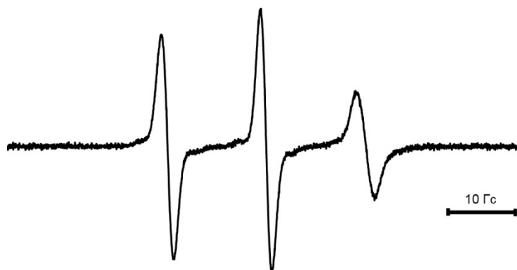
Рис. 29. Спектр ЭПР парамагнитной пробы RSG (0,2 мМ, рН 7,4). Спектр записан в X-диапазоне при следующих настройках: мощность микроволнового излучения 1 мВт, амплитуда модуляции 0,1 Гс, константа времени, 10,24 мс, время сканирования спектра, 164 с.
