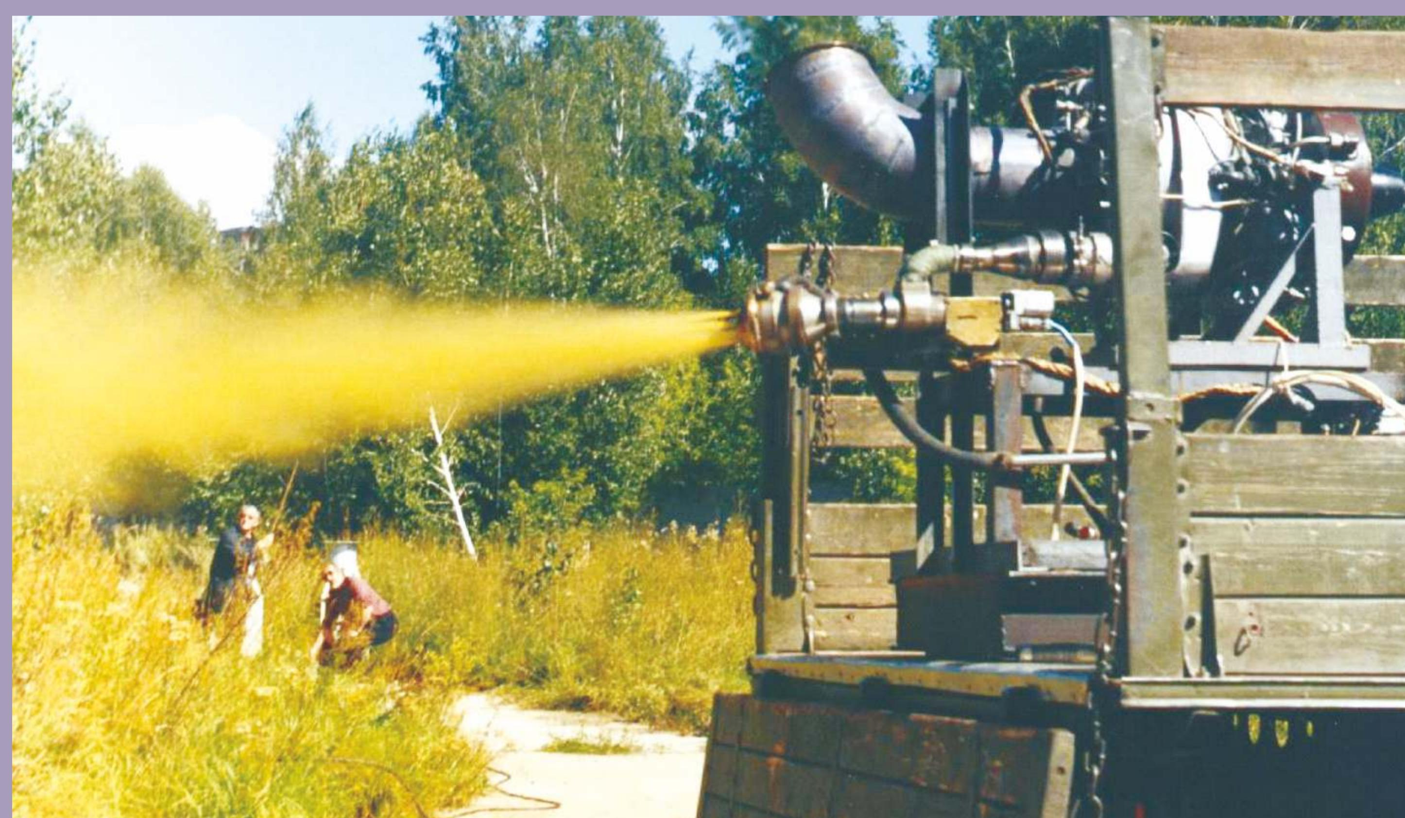
Аэрозольный генератор с регулируемой дисперсностью на основе вспомогательной авиационной установки АИ-9 (ГРД)
