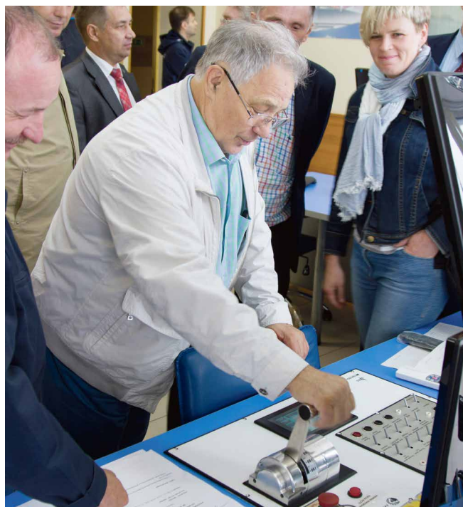
Пульт управления стенда. Академик В.М. Фомин выводит рычаг управления двигателем на взлетный режим
